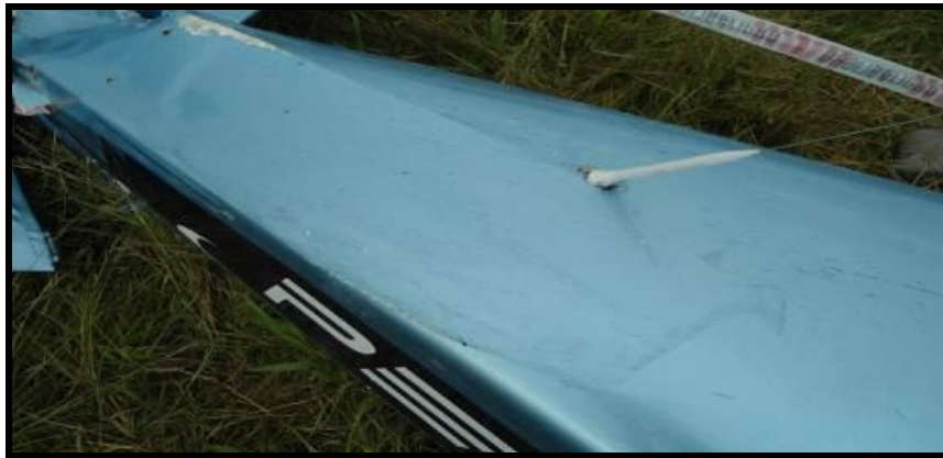
Fig. 6. Impacto sobre la parte superior del empenaje del LV-BSH.
