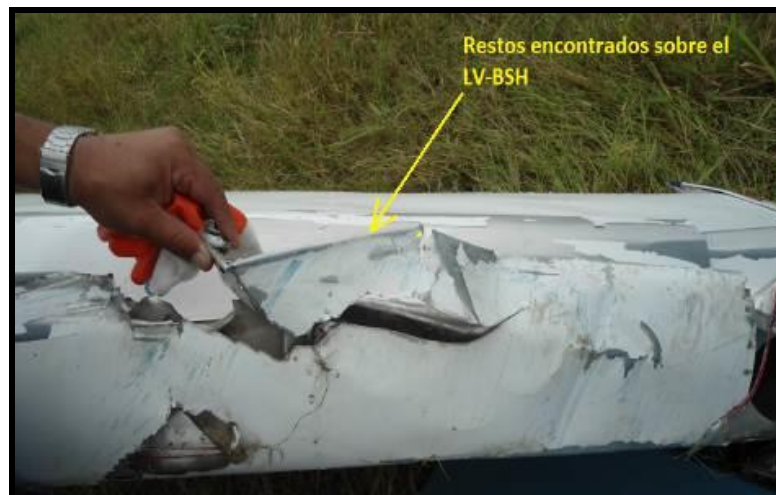
Fig. 8. Golpe y marcas con transferencia de pintura en el borde de ataque del ala izquierda del LV-CQJ
