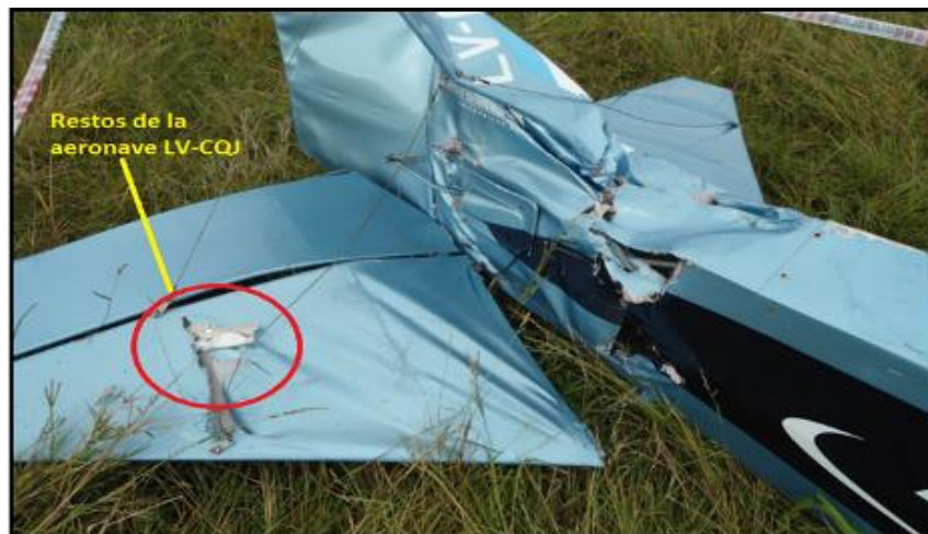
Fig. 7. Golpe en el estabilizador fijo horizontal y en el estabilizador fijo vertical del LV-BSH.
