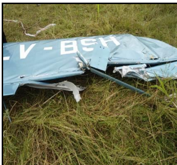
Fig. 5. Golpe en el borde fuga y alerón derecho del LV-BSH.
