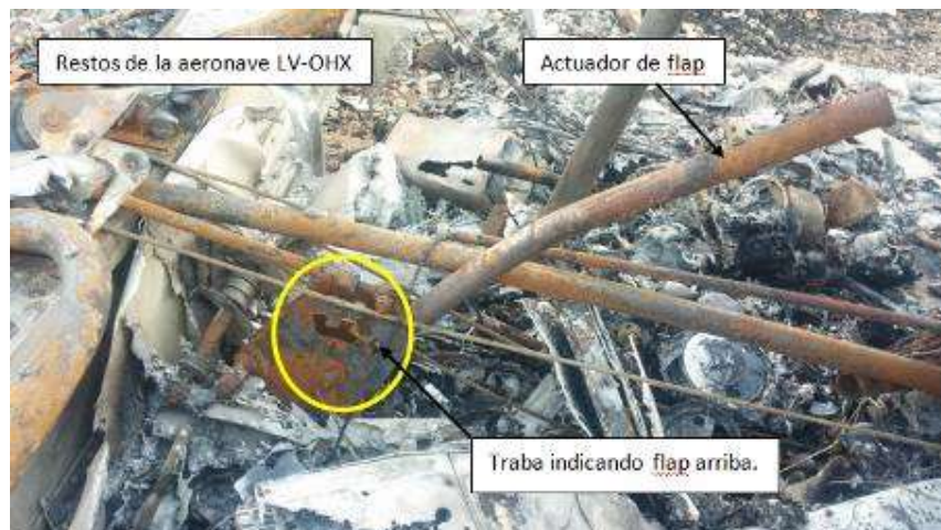
Figura 15. Palanca de flaps trabada en posición "arriba"
