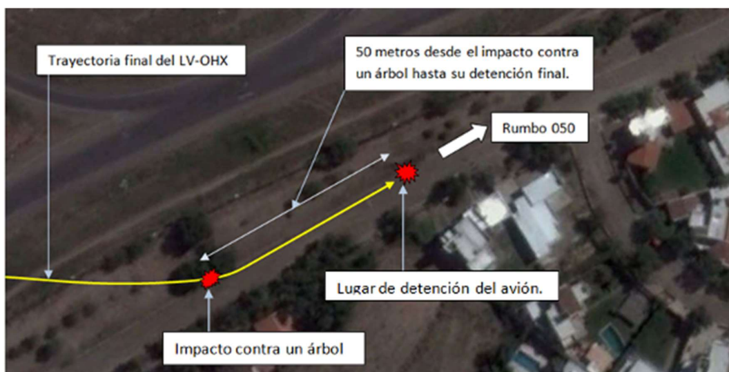
Figura 6. Trayectoria aproximada de la aeronave en el aterrizaje de emergencia
