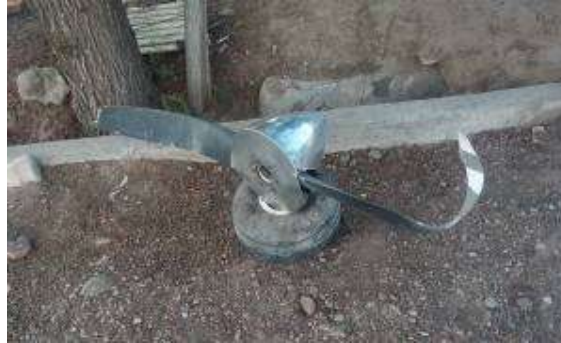
Figura 4. Daños en la hélice
