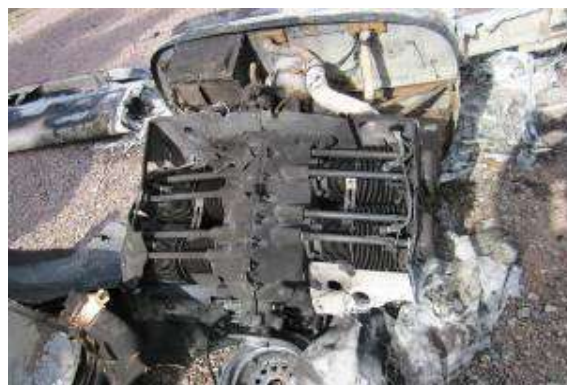
Figura 3. Daños en el motor
