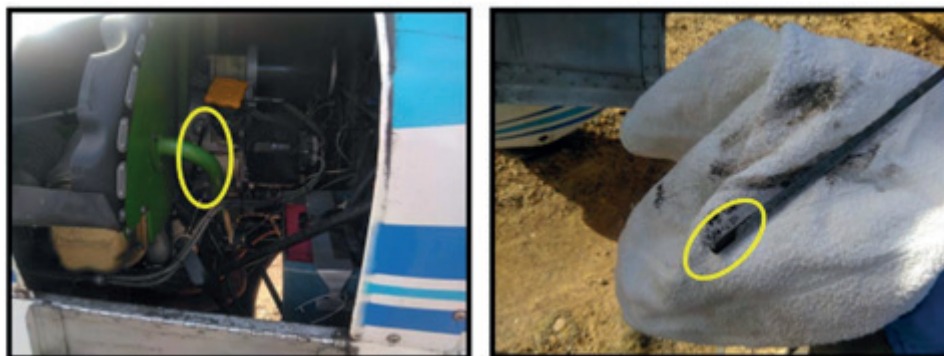
Figura 1. Comprobación de la cantidad de aceite con la varilla de medición.
